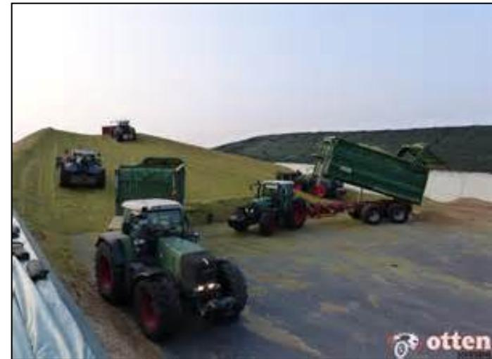
Beim Einfahren und bei Entnahme der Silage werden die Fugen extrem beansprucht. Es ist kaum zu vermeiden, dass **mechanische Belastungen durch Befahren** verursacht werden, durch Silage etc. auf den Fugen!
