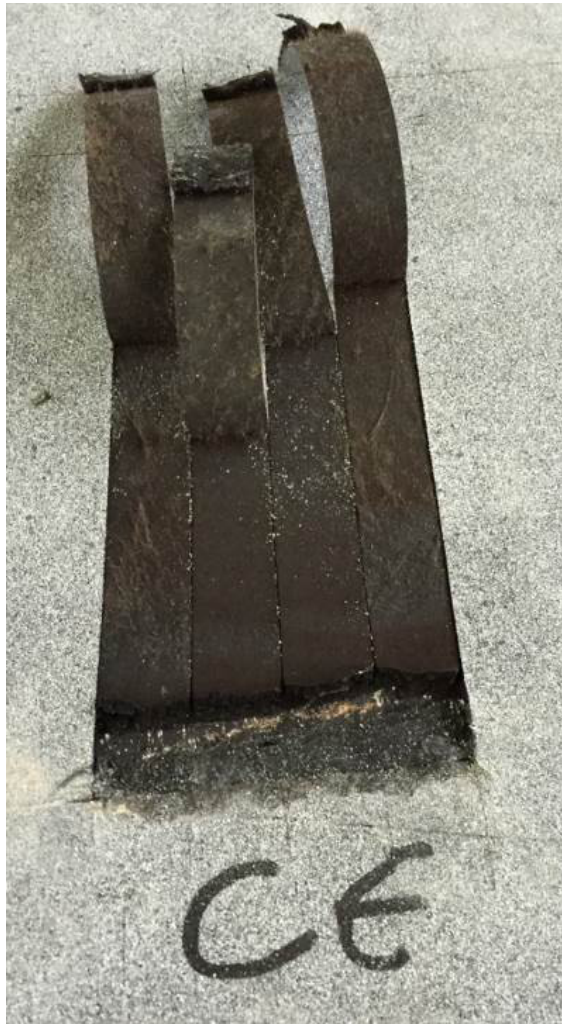
Trennfall A: Trennung in der Bitumen-Schweißbahn
