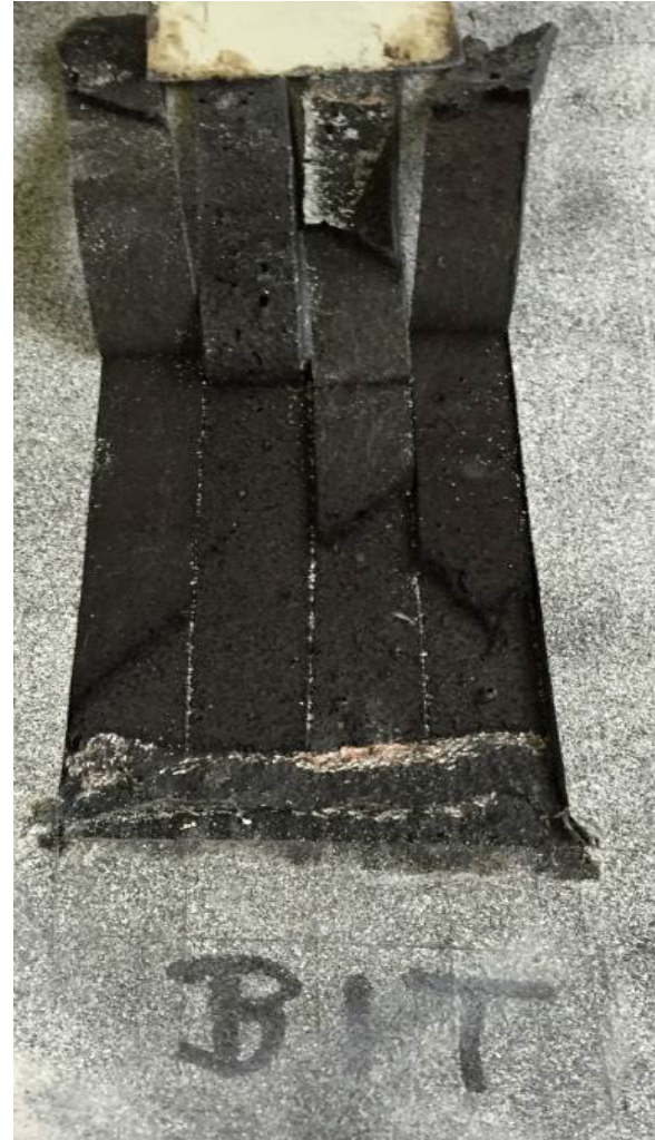
Trennfall A: Trennung in der Bitumen-Schweißbahn
